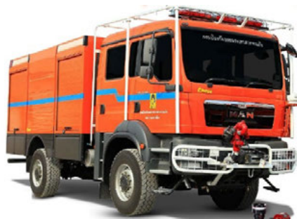
林野火災用ポンプ車（運転席を火災から守る水のカーテン（白いパイプ）が備わっている。）
