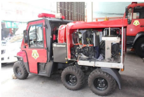
ATV と呼ばれる小型 6 輪消防車 All-Terrain Vehicle (全地形対応車) の略で、泡放 射など様々な消火が可能である。
