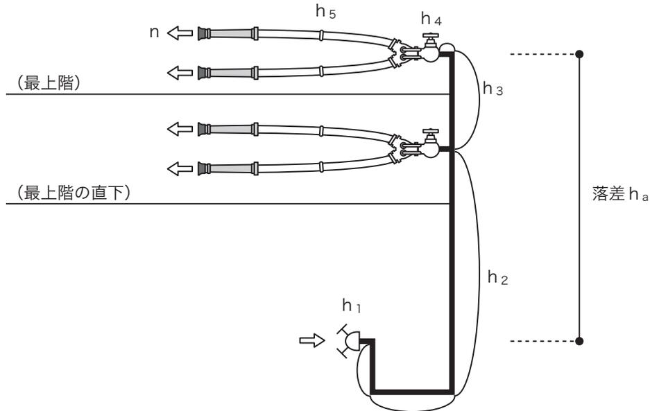
(注) 計算式は、計算上において、消防ポンプ自動車から設計送水圧力 (最大1.6MPa) により送水口より送水された圧力水が最低となる最上階において一の放水口からホース2線を延長し、最上階の直下階において一の放水口からホース2線を延長して、それぞれのノズルから省令第31条第5号口かっこ書きで規定する放水圧力で放水することとしたものである。
