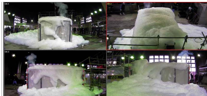
○ 高発泡消火設備の危険物施設への設置条件に関する検証実験
