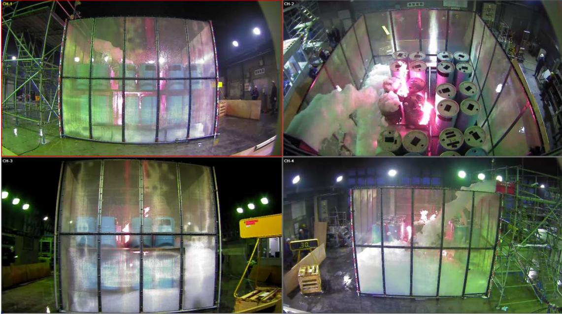
カメラ画像の例（高発泡消火設備の危険物施設への設置条件に関する検証実験）
